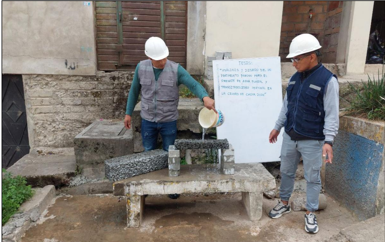
Figura 5. Prueba de simulación de lluvia en especímenes de concreto poroso
